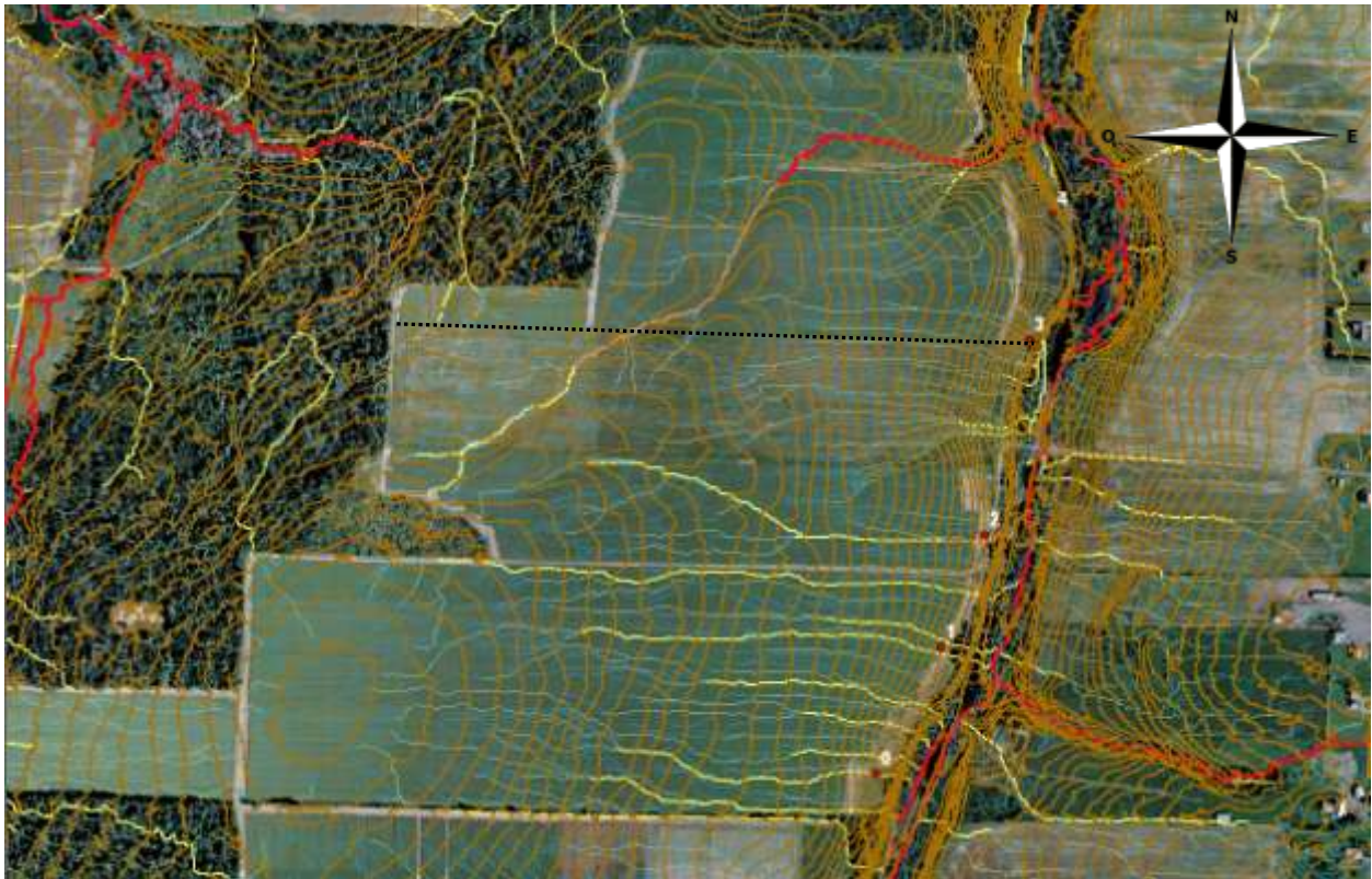
Photo 30: Site 4 avec les lignes topographiques, lignes d'accumulation du ruissellement et segments de mesure des pentes.
