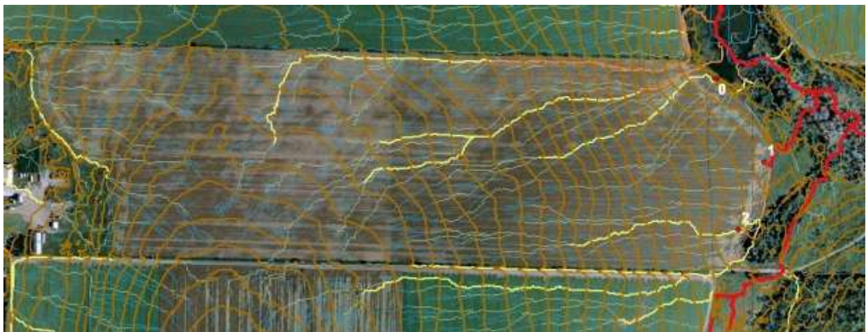
Photo 39: Site 3a avec les lignes topographiques, lignes d'accumulation du ruissellement et segments de mesure des pentes (0, 1 ,2)
